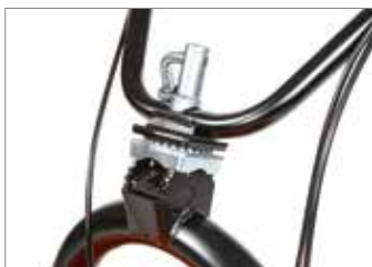
Manubrio regolabile in verticale ed orizzontale tramite l'apposita leva a manubrio.
