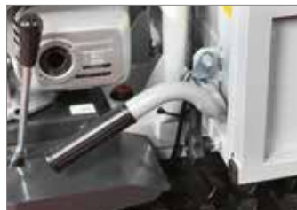
Ribaltamento manuale con sistema di bloccaggio automatico.
