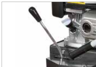
Comando selettore delle velocità con leva.
