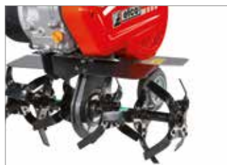
Fresa a tre elementi per lato da 46 cm restringibile a 32-22 cm.
